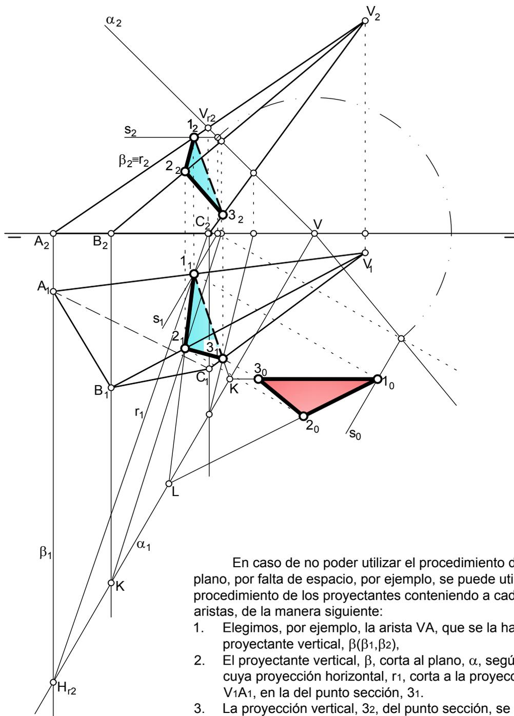
En caso de no poder utilizar el procedimiento de cambio de plano, por falta de espacio, por ejemplo, se puede utilizar el procedimiento de los proyectantes conteniendo a cada una de las aristas, de la manera siguiente:
