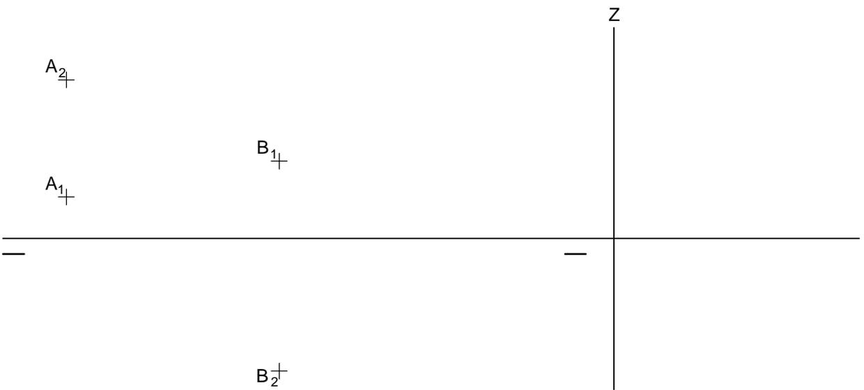
Dadas dos proyecciones de los puntos, A y B, determinar sus simétricos respecto del segundo bisector. Deducir una regla general, para este tipo de simetría.
