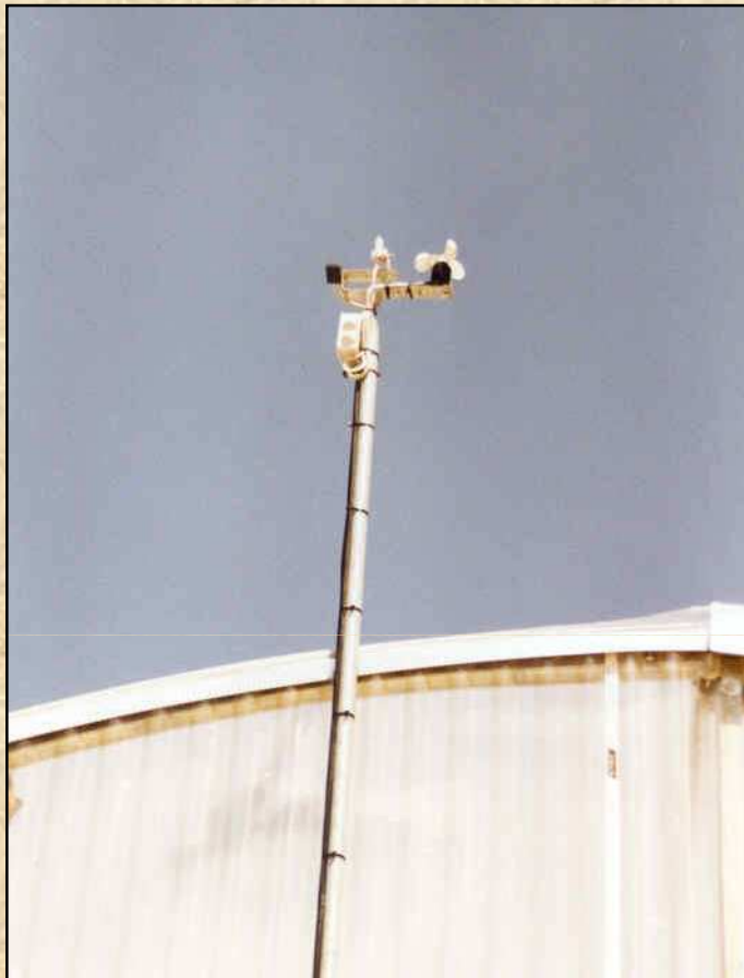
Medidores climáticos: anemómetro, termómetro, fotómetro y pluviómetro
