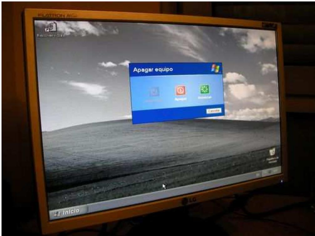
Extraer el CD de **instalación de Windows XP** e insertar el CD de **instalación de Linux Ubuntu** y pulsar sobre el botón **Reiniciar ...**
