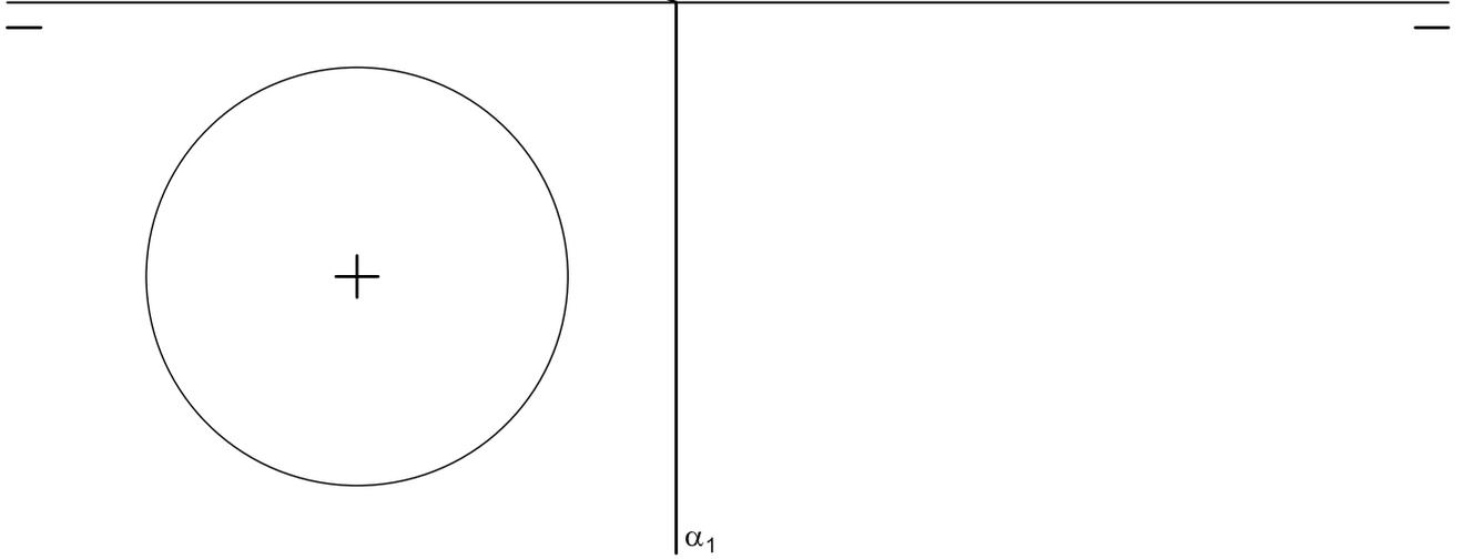
Dibujar la sección producida por el plano  $\alpha$  al cilindro recto de base circular de altura 50 mm, obteniendo su verdadera magnitud. en la parte inferior de la lámina obtener el desarrollo del cilindro y de la sección.
