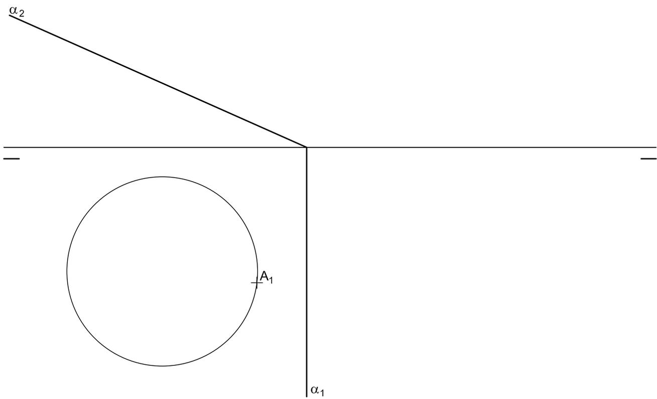
Dibujar la sección producida por el plano  $\alpha$  al prisma recto regular pentagonal de altura 50 mm, obteniendo su verdadera magnitud. En la parte inferior de la lámina obtener el desarrollo del prisma y de la sección. Se da la posición de la proyección horizontal de uno de los vértices.
