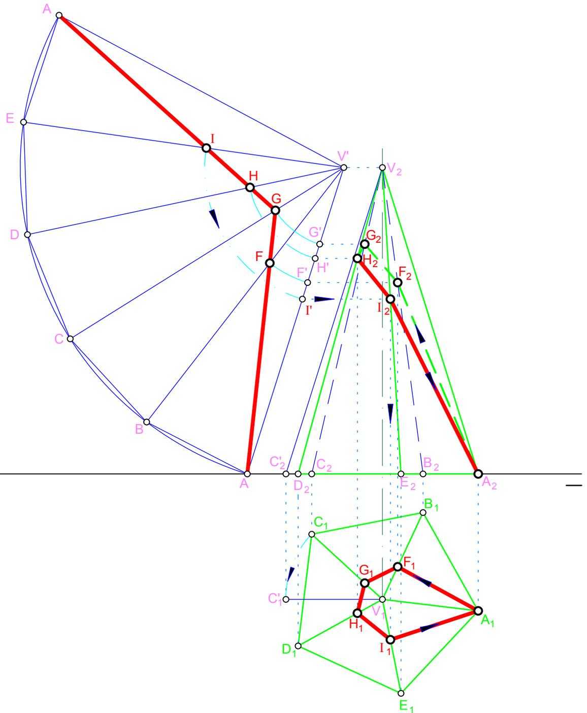
El proceso para determinar el camino mínimo o cualquier otro camino, es el inverso al seguido en la obtención del desarrollo y transformada de la sección que un plano produce a un cuerpo; veamos los pasos a seguir:
