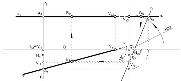
Dada la recta, r, de perfil por su proyección de perfil r 3; situar en ella el punto A, conocida su proyección vertical. Dibujar por el punto A una recta horizontal, s. cuya proyección horizontal forme con la LT un ángulo de 15° y situar en esta recta un punto B, que diste de la LT 32 mm.
