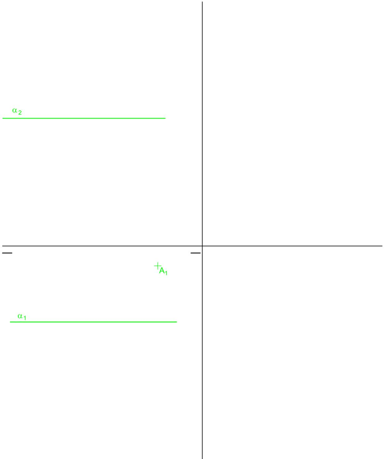
Dibujar las proyecciones y verdadera magnitud de un rombo áureo, apoyado en el plano  $\alpha$ , cuya diagonal mayor AC, que mide 70 mm, tiene su vértice C en la traza horizontal,  $\alpha_1$ , del plano  $\square$  y a la izquierda del vértice A. El rombo está en el 1º cuadrante. Abatir sobre los tres planos: PH, PV y PP.
