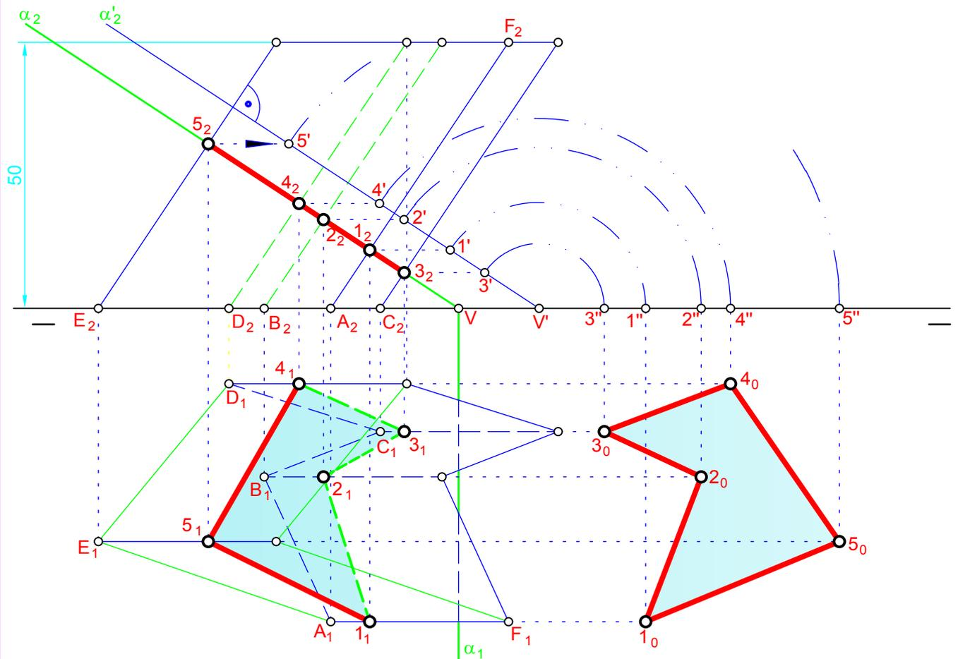
Dibujar la sección producida por el plano  $\alpha$  al prisma oblicuo de altura 50 mm y base cóncava, siendo sus aristas laterales rectas frontales; obtener su verdadera magnitud. En la parte inferior de la lámina dibujar el desarrollo del prisma y de la sección. Se da la proyección horizontal de la base y la horizontal y vertical de la recta donde está una de las aristas laterales.
