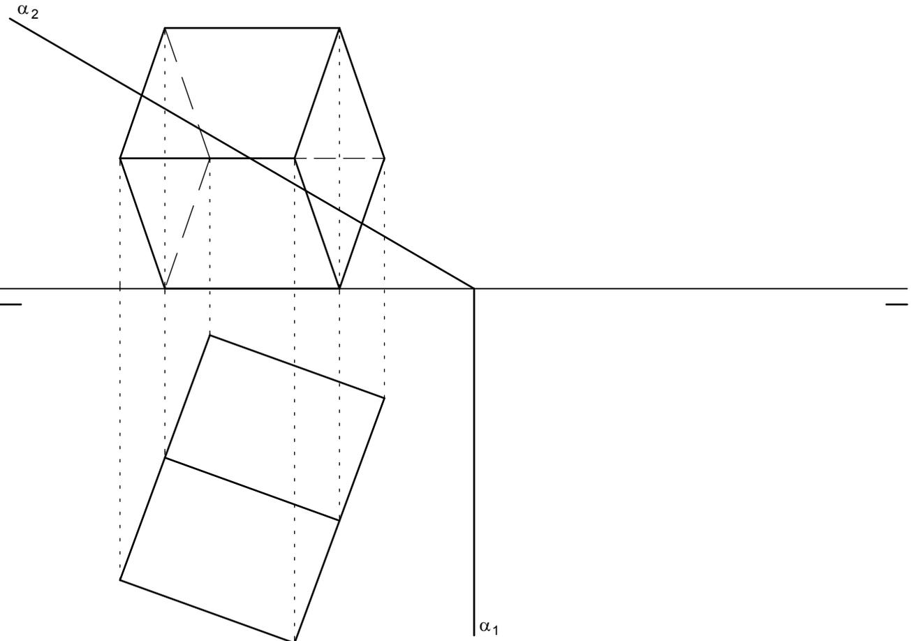
Aprovechando una de las posiciones vistas en la lámina 18, se pide seccionar el cubo por el plano  $\alpha$ , obteniendo su verdadera magnitud y el desarrollo del cubo así como de la sección en la parte inferior de la lámina.
