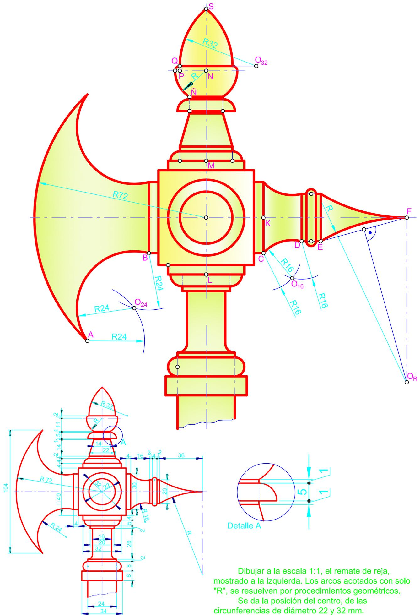
Dibujar a la escala 1:1, el remate de reja, mostrado a la izquierda. Los arcos acotados con solo "R", se resuelven por procedimientos geométricos. Se da la posición del centro, de las circunferencias de diámetro 22 y 32 mm.
