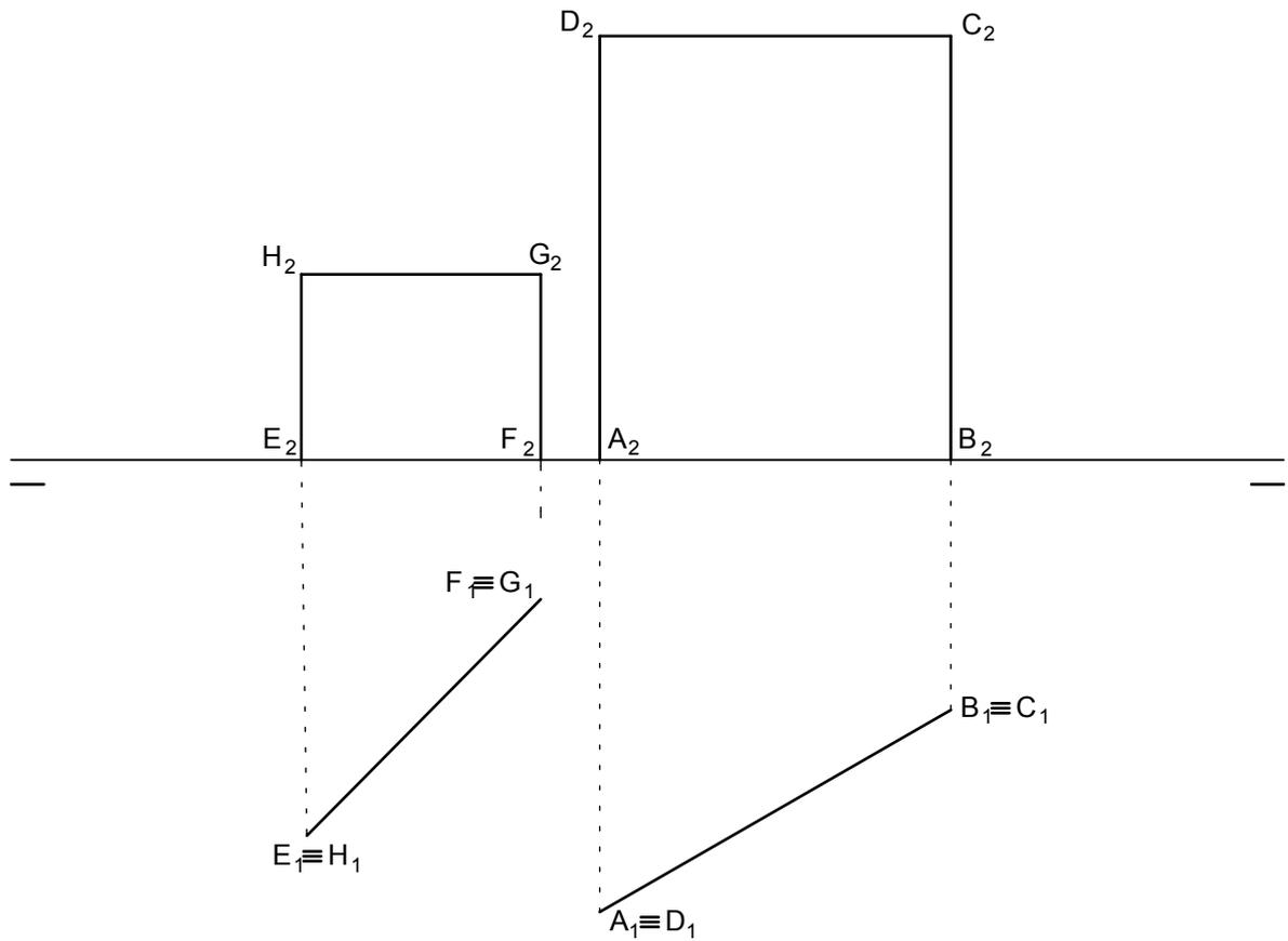
Un muro ABCD de espesor despreciable, por efecto del viento se dobla por su diagonal BD, determinar las nuevas proyecciones del vértice C, cuando éste toca el PH, así como las nuevas proyecciones del trozo de muro doblado. el muro no sufre ninguna deformación.
