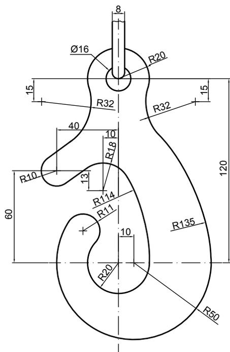
Dibujar a la escala 1:1 el Gancho de Fundición, mostrado a la izquierda. Se da la posición del centro del orificio para la cadena.
