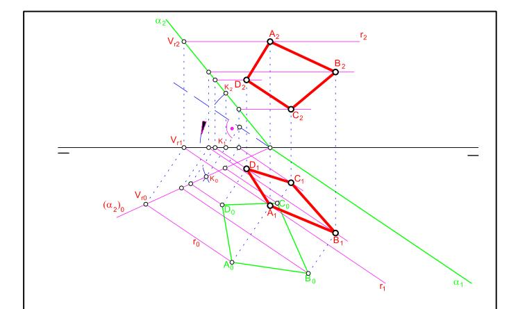
Obtener las proyecciones del cuadrilátero irregular, contenida en el plano  $\alpha$ . Utilizar el procedimiento de las horizontales.
