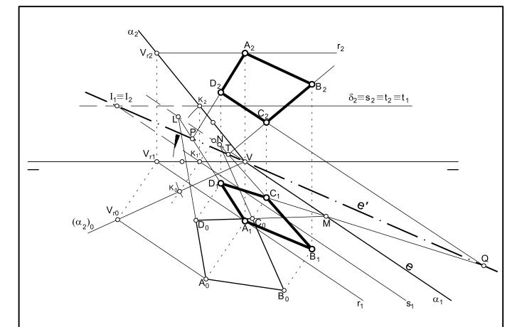
Obtener las proyecciones del cuadrilátero irregular, contenida en el plano  $\alpha$ . Utilizar el procedimiento de afinidad.
