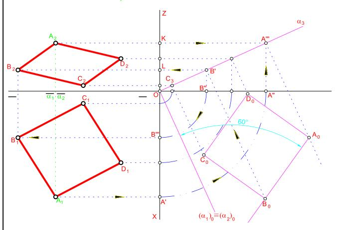
Obtener las proyecciones del cuadrado de lado 40 mm, contenida en el plano  $\alpha$ . Uno de sus lado forma con la traza horizontal  $\alpha$ 1, un ángulo de  $60^{\circ}$ , creciendo de izquierda a derecha. El vértice A es el de mayor cota posible.
