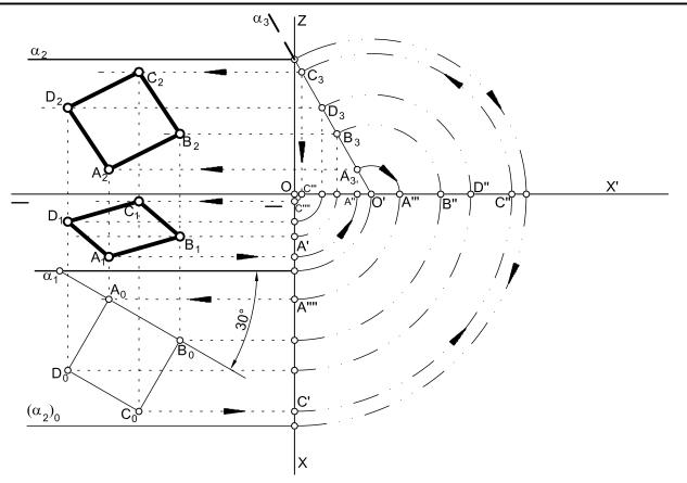
Obtener las proyecciones del cuadrado de lado 20 mm, contenida en el plano  $\alpha$ . Uno de sus lado forma con la traza horizontal  $\alpha_1$ , un ángulo de 30°, creciendo de izquierda a derecha. El vértice A es el de menor cota posible.
