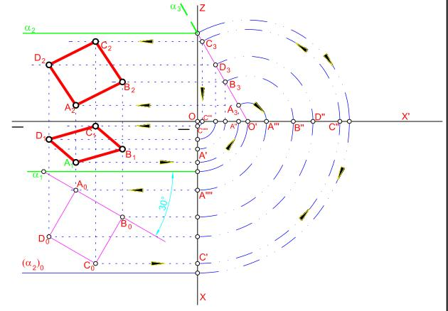
Obtener las proyecciones del cuadrado de lado 20 mm, contenida en el plano  $\alpha$ . Uno de sus lado forma con la traza horizontal  $\alpha_1$ , un ángulo de  $30^\circ$ , creciendo de izquierda a derecha. El vértice A es el de menor cota posible.
