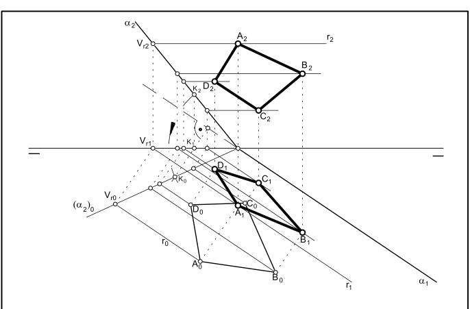
Obtener las proyecciones del cuadrilátero irregular, contenida en el plano  $\alpha$ . Utilizar el procedimiento de las horizontales.
