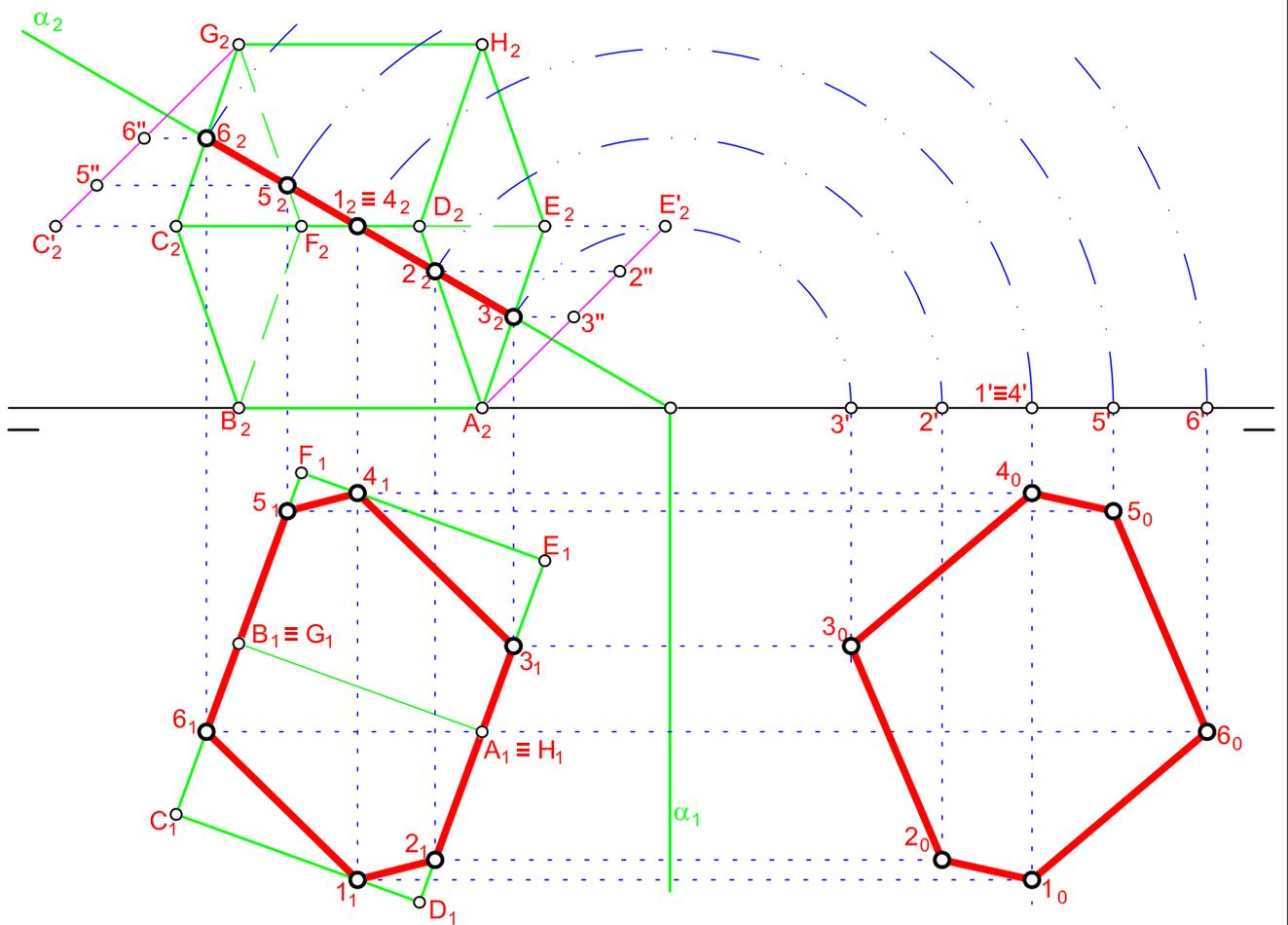
Aprovechando una de las posiciones vistas en la lámina 26, se pide sectionar el cubo por el plano  $\alpha$ , obteniendo su verdadera magnitud y el desarrollo del cubo así como de la sección en la parte inferior de la lámina.
