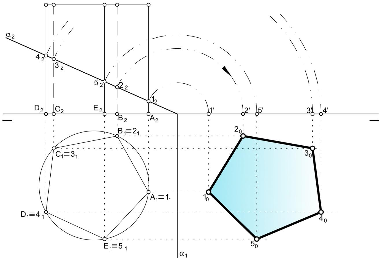
Dibujar la sección producida por el plano  $\alpha$  al prisma recto regular pentagonal de altura 50 mm, obteniendo su verdadera magnitud. En la parte inferior de la lámina obtener el desarrollo del prisma y de la sección. Se da la posición de la proyección horizontal de uno de los vértices.
