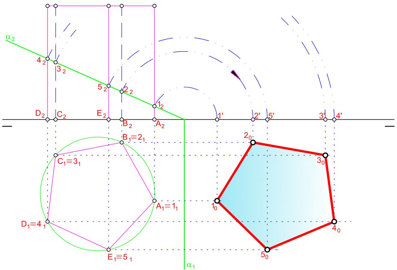
Dibujar la sección producida por el plano  $\alpha$  al prisma recto regular pentagonal de altura 50 mm, obteniendo su verdadera magnitud. En la parte inferior de la lámina obtener el desarrollo del prisma y de la sección. Se da la proyección horizontal de un de los vértices.
